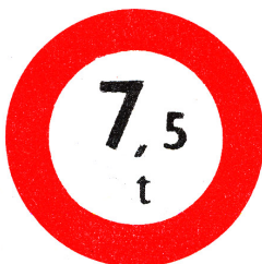
35b Zákaz vjazdu vozidiel, ako pri značke-č. 35a, dovoľujúci však vjazd na most jedinému vozidlu až do celkovej váhy*) vyznačenej pod značkou
