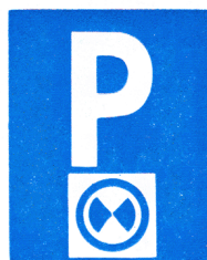
D 11d Parkovisko s parkovacím kotúčom
