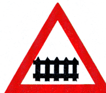
A 23 Železničné priecestie so závorami
