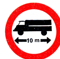
B 17 Základná značka zákazu vjazdu vozidiel alebo súprav vozidiel, ktorých dĺžka presahuje vyznačenú hranicu
