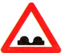
A 7 Nerovnosť vozovky
