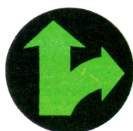
S 1b Kombinovaný signál pre priamy smer a odbočovanie vpravo (zelené šípky)
