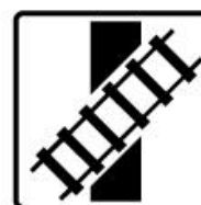
E 10 Tvar kríženia cesty so železničnou dráhou
