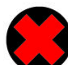
S 5a Signál pre zakázaný vjazd vozidiel do jazdného pruhu
