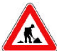
A 17 Práca na ceste
