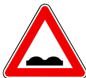
A 5 Nerovnosť vozovky
