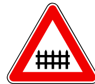
A 23 Železničné priecestie so závorami
