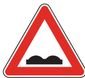
A 5 Nerovnosť vozovky
