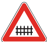
A 23 Železničné priecestie so závorami
