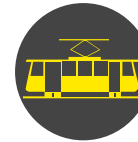
S 11e Doplnkový signál s prerušovaným žltým svetlom v tvare električky
