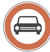
B 4 Zákaz vjazdu všetkých motorových vozidiel s výnimkou motocyklov bez postranného vozíka
