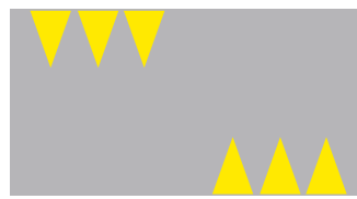
Z 6b Stavebný spomaľovací prah (označenie)
