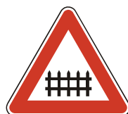
A 25 Železničné priecestie so závorami
