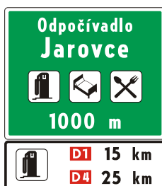
II 18a Odpočívadlo s objektmi služieb (vzor)
