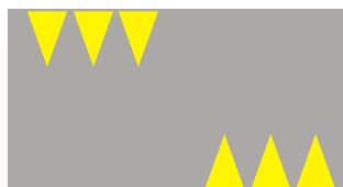
Z 6b Stavebný spomaľovací prah (označenie)
