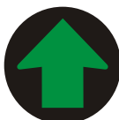
S 2c Signál so zeleným svetlom pre jeden smer so znamením „Voľno“ (vzor)
