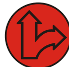
S 3a Kombinovaný signál s červeným svetlom pre dva smery so znamením „Stoj!“ (vzor)
