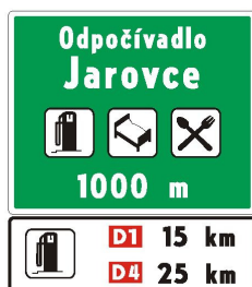
II 18a Odpočívadlo s objektmi služieb (vzor)
