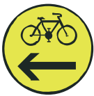
S 7e Signál pre cyklistov so žltým svetlom pre jeden smer so znamením „Pozor!“ (vzor)
