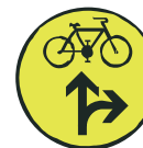
S 7h Signál pre cyklistov so žltým svetlom pre dva smery so znamením „Pozor!“ (vzor)
