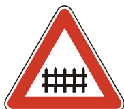
A 25 Železničné priecestie so závorami
