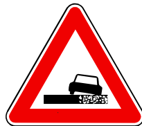
A 6 Nebezpečná krajnica
