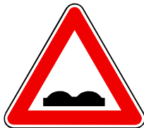
A 5 Nerovnosť vozovky
