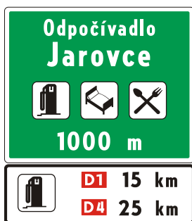
II 18a Odpočívadlo s objektmi služieb (vzor)
