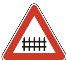
A 25 Železničné priesectie so závorami
