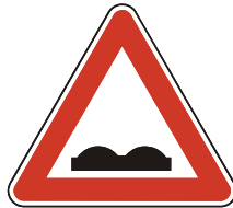
A 5 Nerovnosť vozovky
