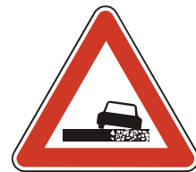
A 7 Nebezpečná krajnica
