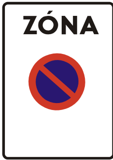
IP 24a Zóna s dopravným obmedzením (vzor)
