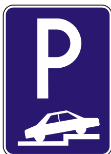
IP 15a Parkovisko – parkovacie miesta s kolmým alebo šikmým čiastočným státím na chodníku
