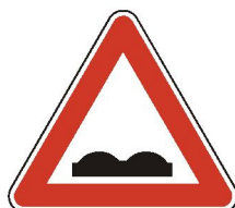
A 5 Nerovnosť vozovky
