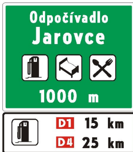
II 18a Odpočívadlo s objektmi služieb (vzor)
