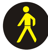
S 11b Doplnkový signál s prerušovaným žltým svetlom v tvare chodca
