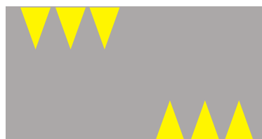
Z 6b Stavebný spomaľovací prah (označenie)
