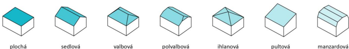
Tabuľka č. 58 Schéma základných typov strešných konštrukcií
